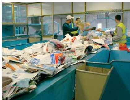
Sortie du séparateur des journaux, revues et magazines vers la table de tri.
