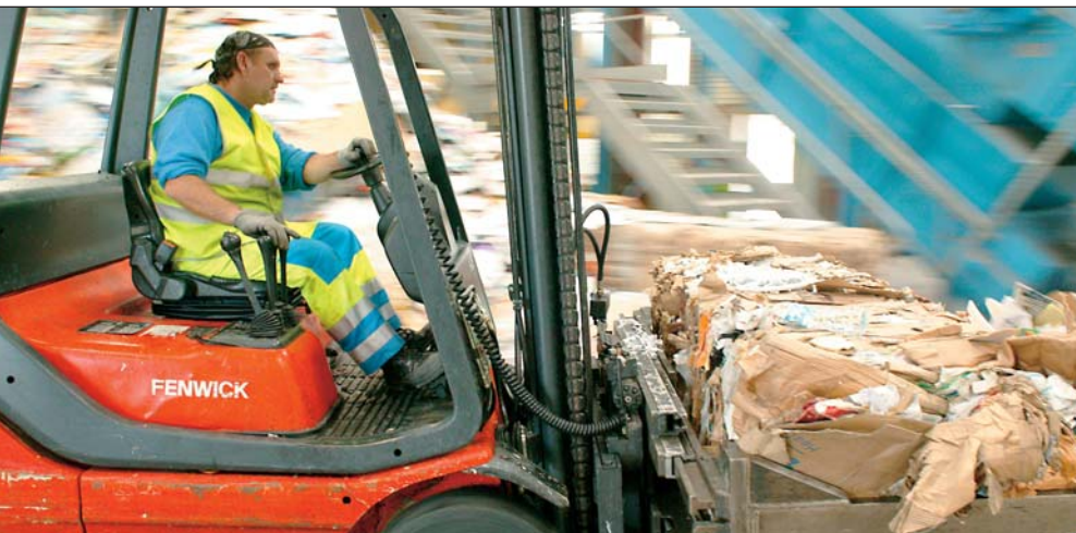
Chargement du tapis de fosse par un chariot élévateur.
